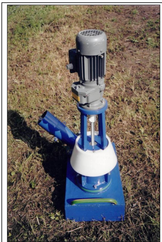
Sv. Ján pod Skalou. Inštalácia DVE 120, DC generátor 12 V.
